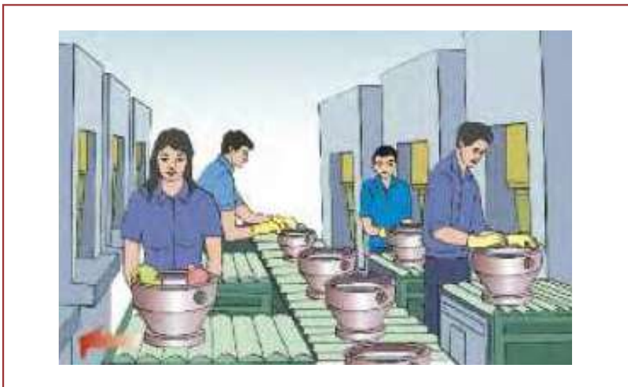
شکل ۳۶- نوار نقاله پاسیو جهت حرکت دادن موتورهای سنگین در ارتفاع کار
