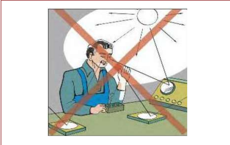
شکل ۲۱- کاهش دید به علت بازتاب نور به صورت غیر مستقیم و ایجاد خیرگی
